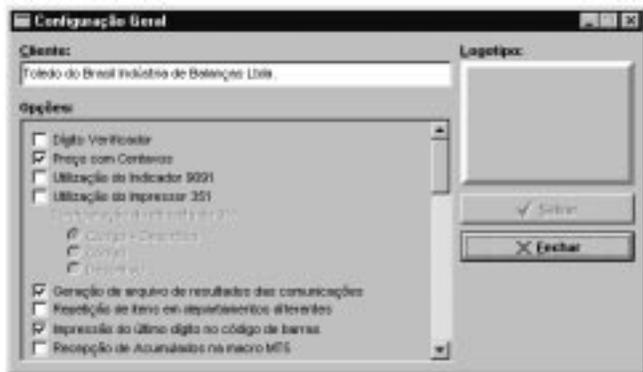
Através da barra de rolagem localize a opção "Port de Endereçamento do Concentrador" e ajuste-a para o endereço configurado através da Dip Switch DS2 na PCI Concentradora.
