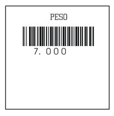
> Configuração 32: permite a impressão do peso líquido em fonte de 8 x 4mm, com ou sem código de barras.
