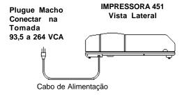
Após conectar o plugue do cabo de alimentação na tomada, levante a tampa basculante e ligue a impressora através da chave LIGA/DESLIGA.
