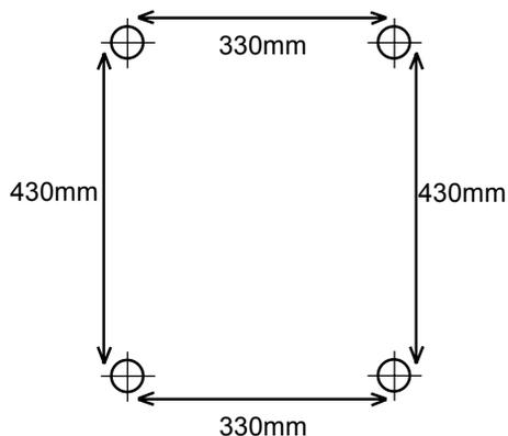
A TOLEDO não fornece os parafusos de fixação. Para fixar o HUB RS-485 com segurança, utilize chumbadores com parafusos M8 ou 5/16".
