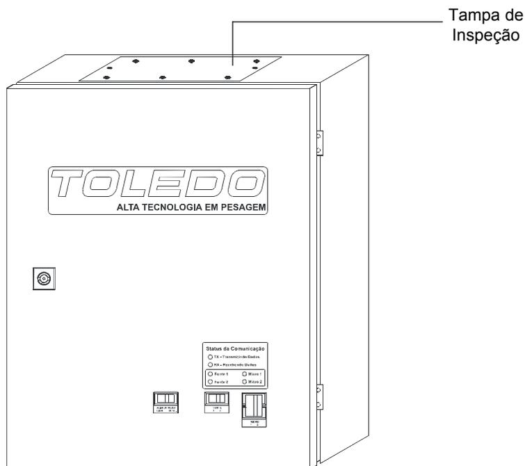
O diâmetro do eletroduto a ser fixado na tampa de inspeção, dependerá da quantidade de balanças que serão interligadas no HUB RS-485. O furo na tampa de inspeção é de responsabilidade do Cliente.
