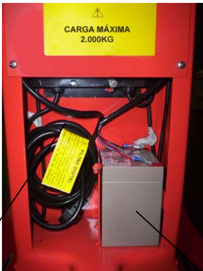
Cabo de alimentação elétrica e recarga da bateria
