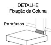
e. Fixe a coluna na plataforma de pesagem com os 4 parafusos fornecidos. Veja detalhe na figura acima.
