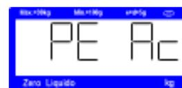
Retire o peso sobre o prato de pesagem, pois o valor está acima de 10% da capacidade da balança, que é o valor máximo para a captura do zero inicial da balança.
