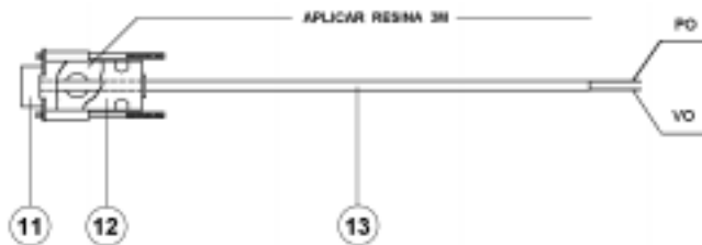
Cabo de Interligação Balança/ PDV MEMOCONTA
